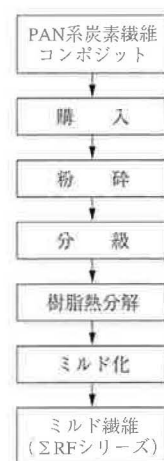
図1 CFRPからの炭素繊維製造のフロー
